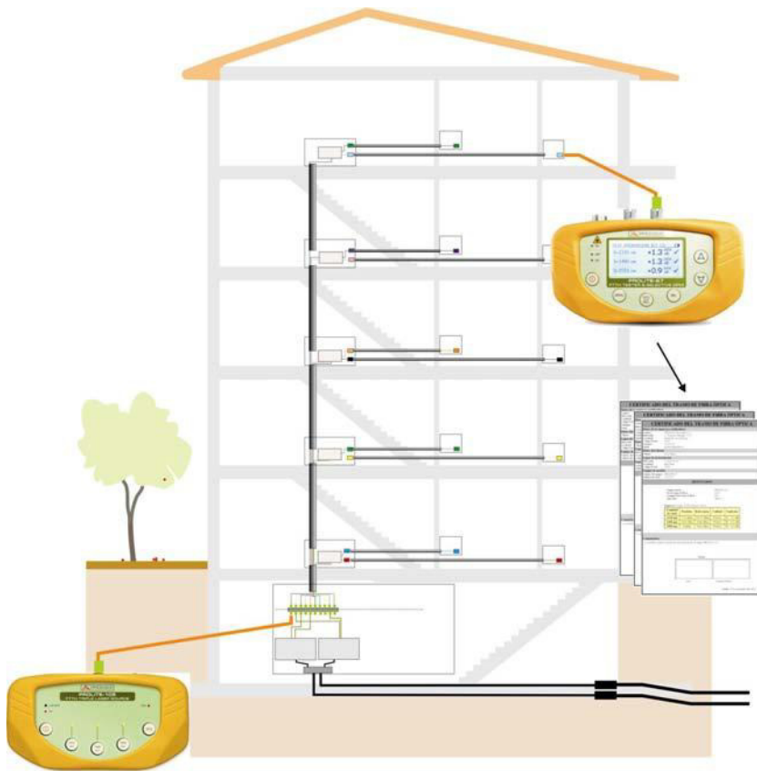
MESURE D'UNE INSTALLATION GENERAL D'UN RESEAU DE FIBRE OPTIQUE
